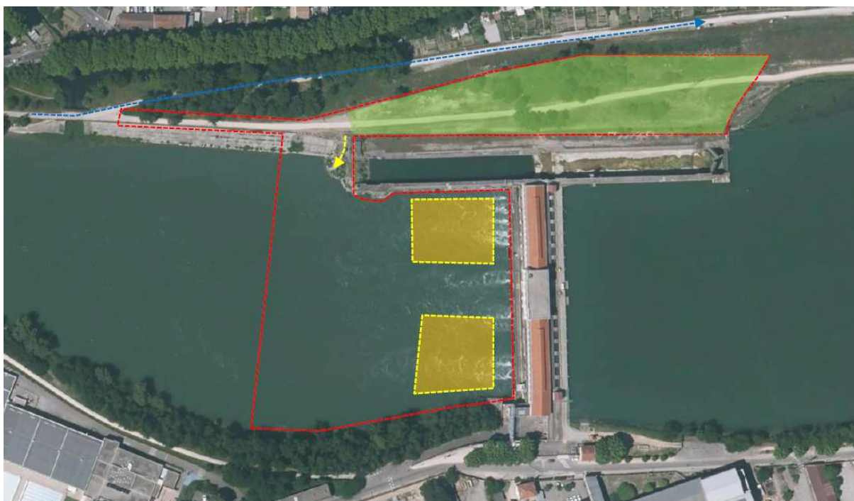
Figure 2 - Emprise du chantier (pointillés rouges) – zone d'installation de chantier (verte) – accès rivière (flèche jaune) – zone de travaux en rivière (zones orange -pointillés jaune), dérivation anneau bleu (pointillés bleus)
